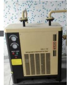
冷冻式压缩空气干燥机
